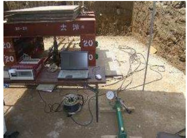
平板載荷試験の実施状況（左側がバックホウで載荷する場合、右側がH鋼・敷鉄板で載荷する場合）
