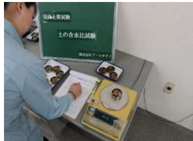
土の含水比試験
