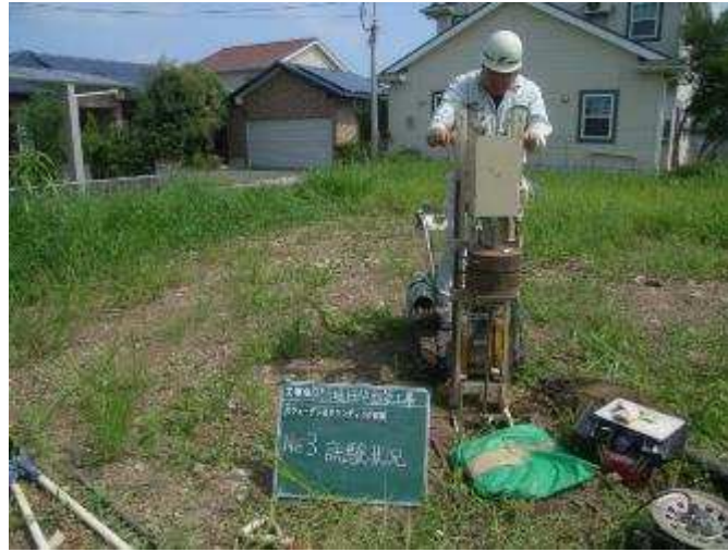
スウェーデン式サウンディングの実施状況
