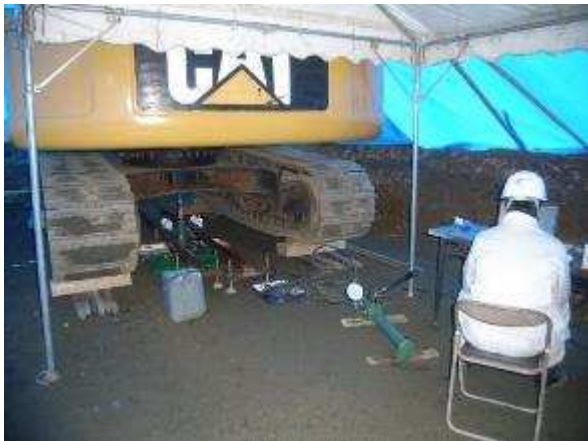
平板載荷試験の実施状況（左側がバックホウで載荷する場合、右側がH鋼・敷鉄板で載荷する場合）
