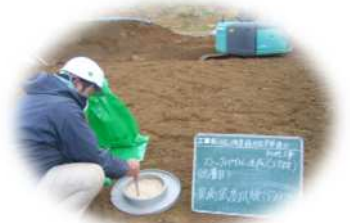
緑川ダムにおける品質管理試験
