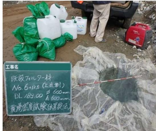
既設フィルター材（φ600mm・h600mm）における現場密度試験・水置換法
