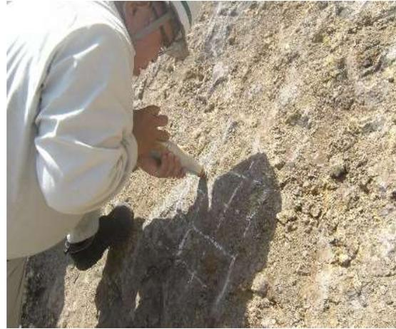
岩盤計測における簡易弾性波測定（左）とシュミットハンマー試験（右）
