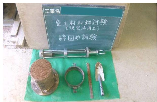
締固め試験
