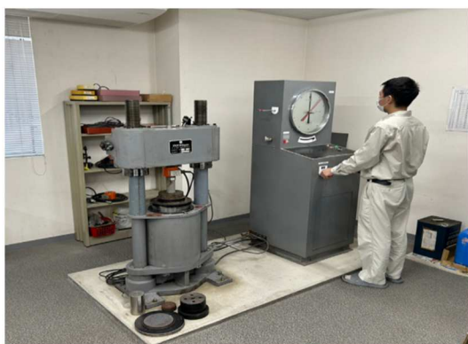
圧縮試験機 (岩石試験用)
