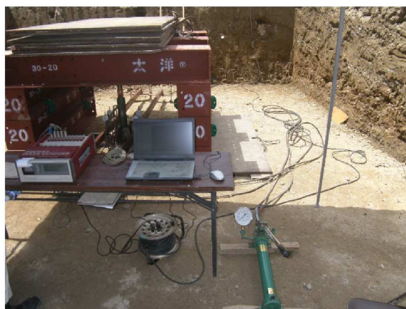
平板載荷試験の実施状況（左側がバックホウで載荷する場合、右側が H 鋼・敷鉄板で載荷する場合）
