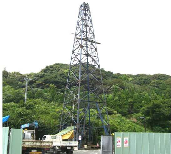
大口径ボーリングマシン リゾート 21 弊社製 25m 級試錐檣
